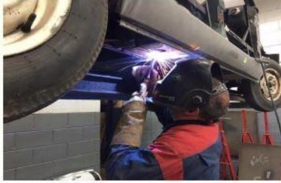
شكل رقم (25): قناع وكفوف الحماية للتلحيم
