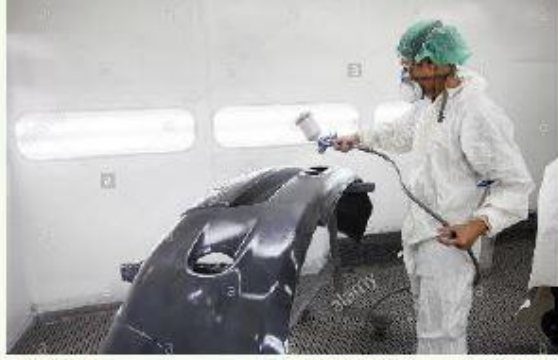
شكل رقم (24): لباس وقناع الحماية للطلاء
